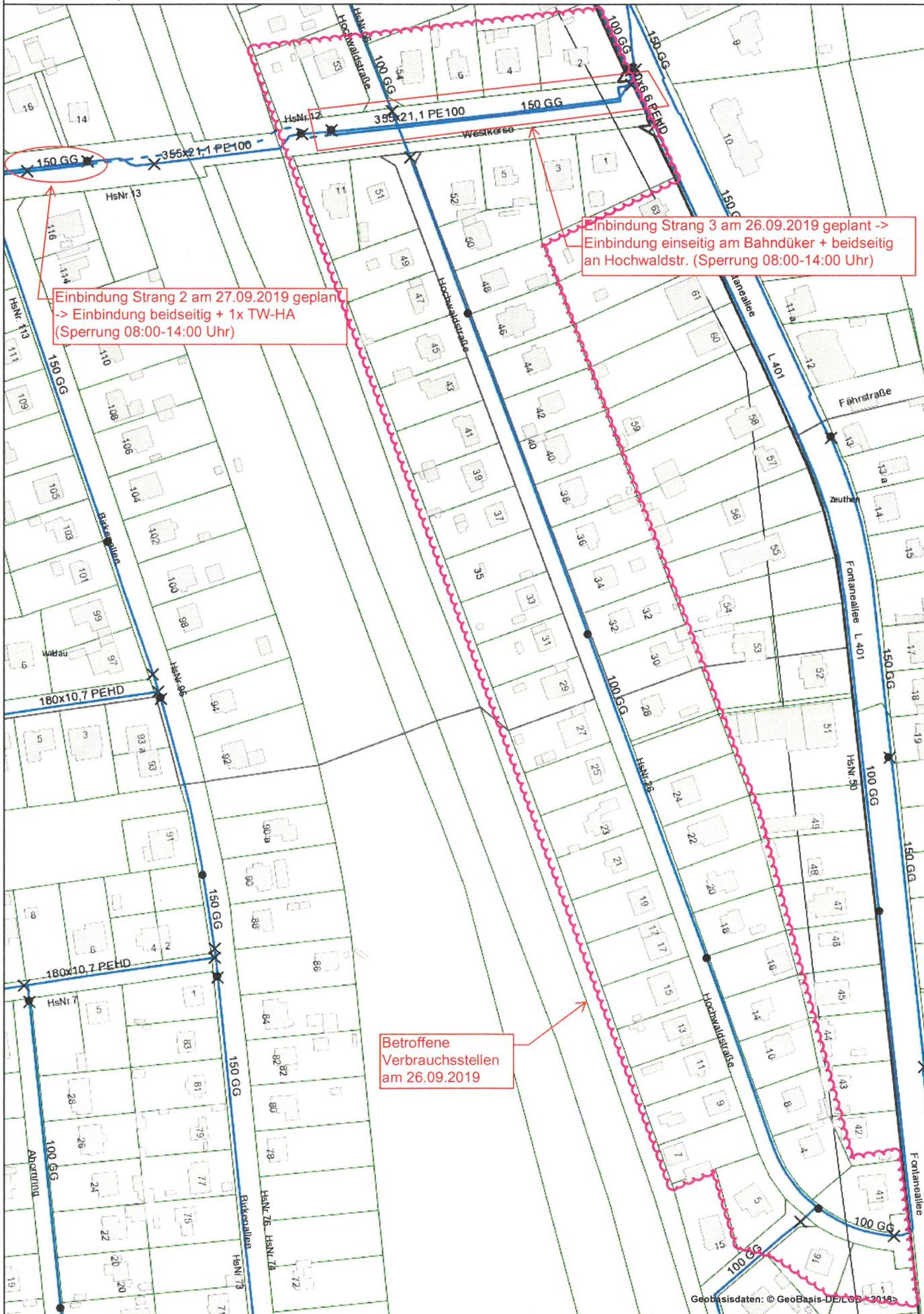
Einbindung Strang 3 am 26.09.2019 geplant -> Einbindung einseitig am Bahndüker + beidseitig an Hochwaldstr. (Sperrung 08:00-14:00 Uhr)
